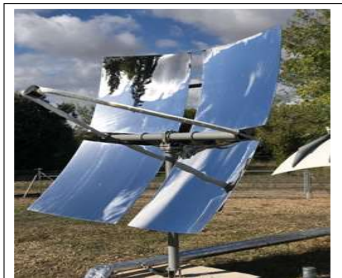
Figuur 2: Compacte twee-assige 360° zonzonvullende zonthermische collector. Deze spiegel kan 3.000 kWh th van 50 graden Celsius leveren; omgerekend 11 GJ, 450 m 3 aardgas of 300 L diesel. De spiegels hebben een gezamenlijke oppervlakte van 4,3 m 2 . Grotere schotelspiegels zijn vaak uitgerust met een stirlingmotor en wekken elektriciteit op. (Foto: TCT, Thermal Cooling Technology)
