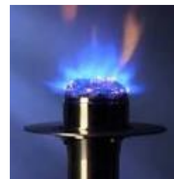
Figuur 68: Voor waterstof ontworpen kop met kleinere gaatjes https://www.gawal
