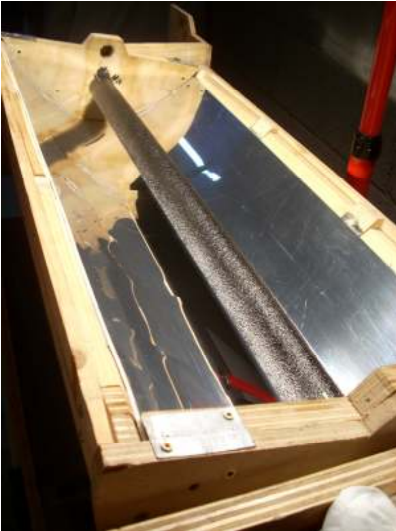
Meting met zwarte pijpisolatie.
