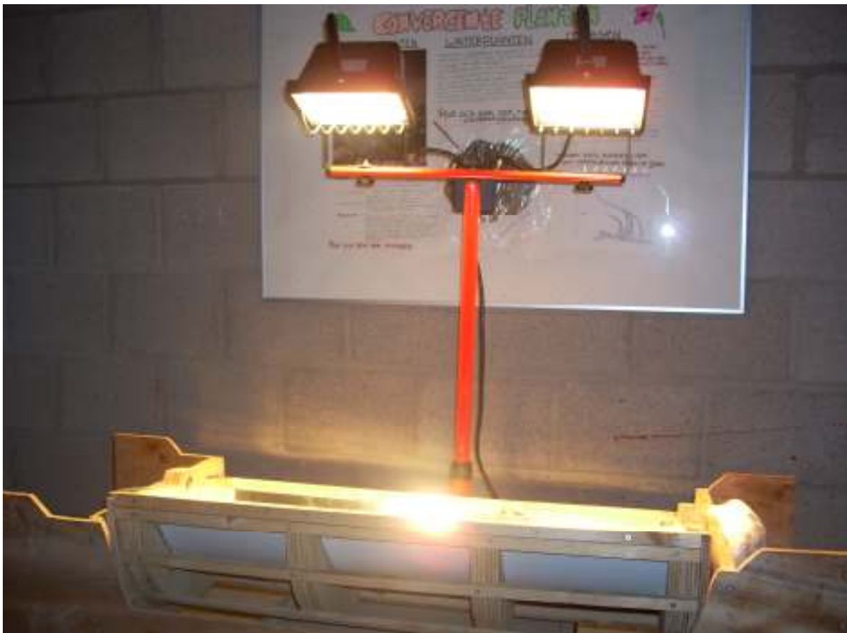
Boven: Bekijk bij de opdracht. Onder: De meting met een zwartgeverfde koperen buis.
